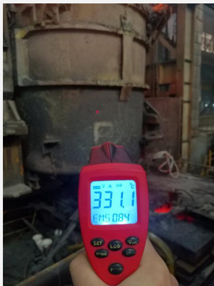
原钢包红外线测试温度
