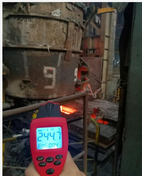
改造后钢包红外线测试温度
